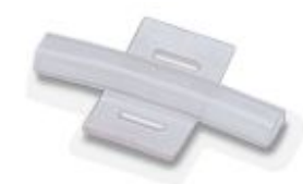
Kabelbezeichnungsträger, transparent, unbeschriftet, längs, Montageart: Einschieben, Kabeldurchmesser: >10 mm, Schriftfeldgröße: 23 x 4 mm
