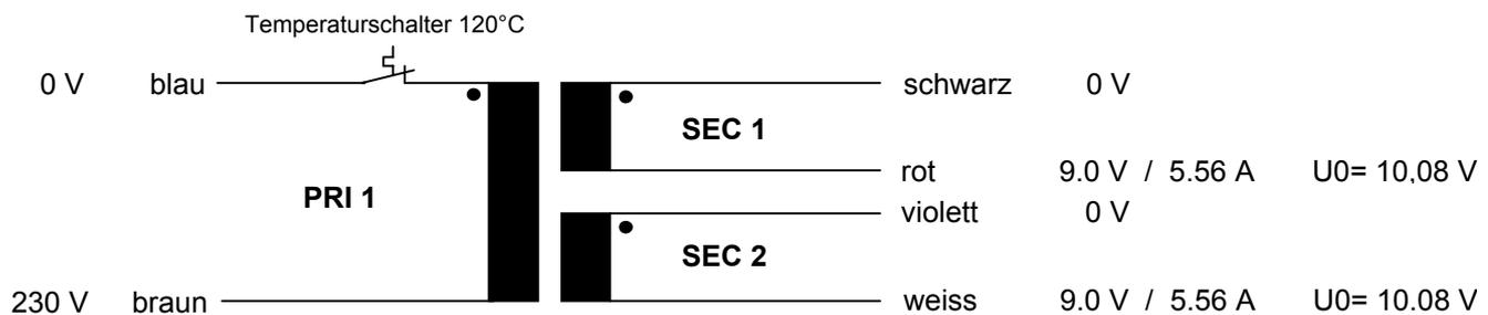
Verschaltungsmöglichkeiten: Parallelschaltung **9.0V / 11.11A** = schwarz mit violett und rot mit weiss verbinden
