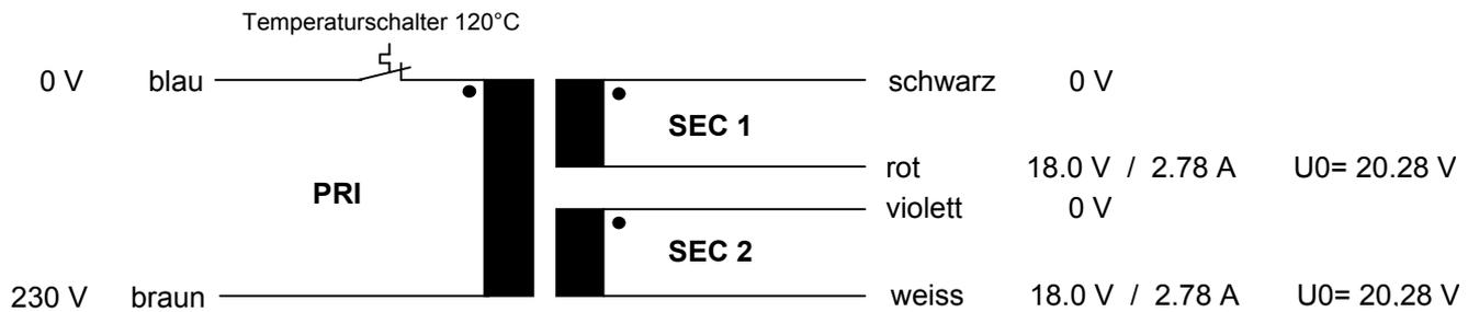
Verschaltungsmöglichkeiten: Parallelschaltung **18.0V / 5.56A** = schwarz mit violett und rot mit weiss verbinden
