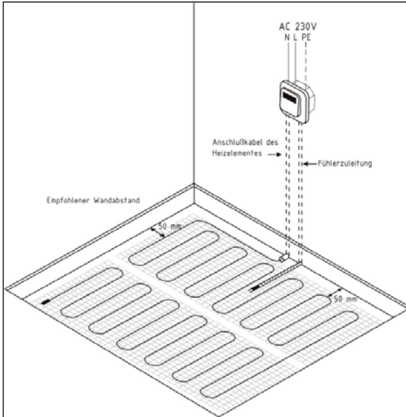
Lage des Bodenfühler zwischen den Mäandern. Hier sehen Sie auch die beiden Leerrohre für den Heizelemente-Anschluss und den Bodenfühler.
