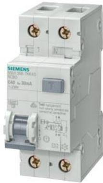
FI/LS-Schalter, 6 kA, 1P+N, Typ A, 30 mA, B-Char, In: 10 A, Un AC: 230 V
