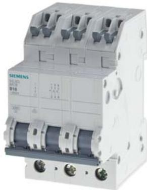
Leitungsschutzschalter 400V 6kA, 3-polig, B, 16A, T=70mm mit schraubenlosen Abgangsklemmen
