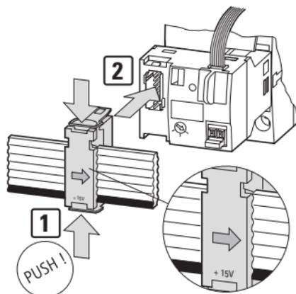
Das PKE32-COM dient als Kommunikationsverbindung zwischen dem PKE-SWD-32 und dem PKE-Auslöseblock. Das PKE-SWD-32 empfängt über das PKE32-COM die Daten des PKE-Auslöseblocks und stellt diese als Eingangsdaten über das SmartWire-DT Netzwerk zur Verfügung.
