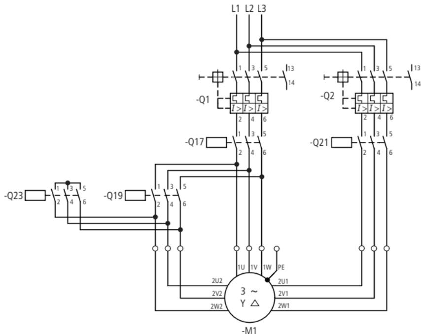
Dimensionierung der Schaltgeräte
