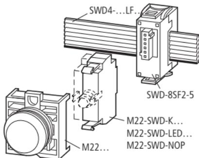
Diese Funktionselemente stehen jeweils in zwei Bauformen für eine Front- oder Bodenbefestigung zur Verfügung. Bodenbefestigungselemente können in Verbindung mit den SWD-Leiterplatten M22-SWD-I... und den IP65-Aufbaugehäusen M22-I... zu dezentralen Bedien- und Anzeigegeräten kombiniert werden.
