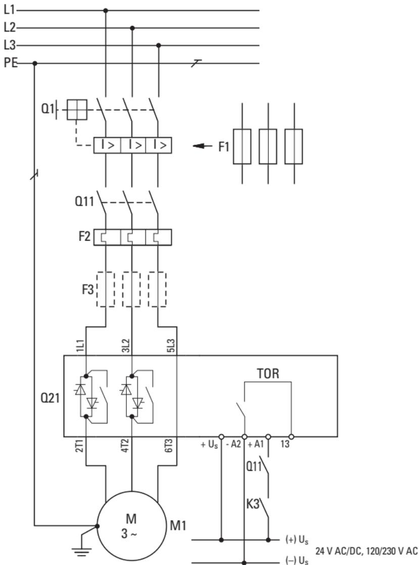
**Elektronische Motorstarter und Drives****Anschlussbeispiel DS7****Ansteuerung mit Netzschütz**
