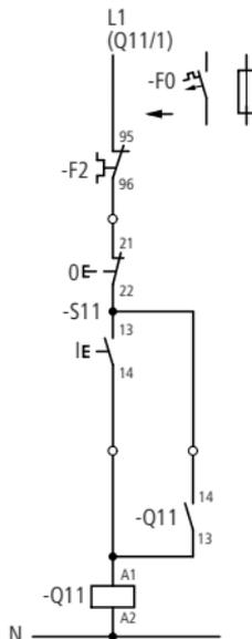
Für die Bemessung von F0 Kurzschlussfestigkeit der Schaltglieder im Stromkreis beachten.
