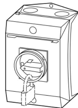
Wartungsschalter werden an elektrischen Maschinen oder Anlagen angebracht, um Wartungsarbeiten unter Beachtung der Sicherheitsregeln gefahrlos zu ermöglichen.
