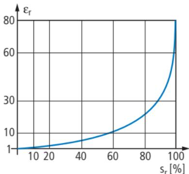
In der nachfolgenden Tabelle sind die Dielektrizitätskonstanten  $\epsilon_r$  einiger wichtiger Stoffe aufgeführt. Aufgrund der hohen Dielektrizitätszahl von Wasser ergeben sich bei Holz relativ große Schwankungen. Feuchtes Holz wird demnach von kapazitiven Sensoren erheblich besser erfasst als trockenes.
