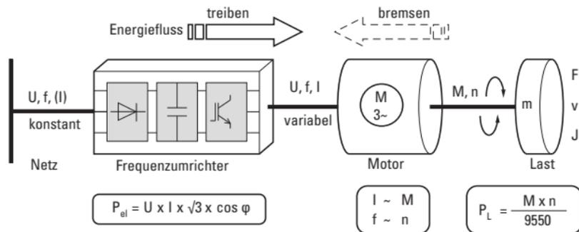
Der Frequenzumrichter wandelt die konstante Spannung und Frequenz des speisenden Netzes in eine Gleichspannung um. Aus dieser Gleichspannung erzeugt er für den Drehstrommotor ein neues, dreiphasiges Netz mit variabler Spannung und variabler Frequenz. Dabei entnimmt der Frequenzumrichter dem speisenden Netz fast nur Wirkleistung ( $\cos \varphi \sim 1$ ).
