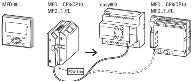
Der COM-LINK ist eine Punkt-zu-Punkt-Verbindung mittels serieller Schnittstelle. Über diese Schnittstelle wird der Status von Ein- und Ausgängen gelesen sowie Merkerbereiche gelesen und geschrieben. Zwanzig Merker-Doppelworte lesen oder schreiben sind möglich. Lesen und Schreiben sind frei wählbar. Diese Daten können Sie für die Sollwertvergabe oder Anzeigefunktionen verwenden.
