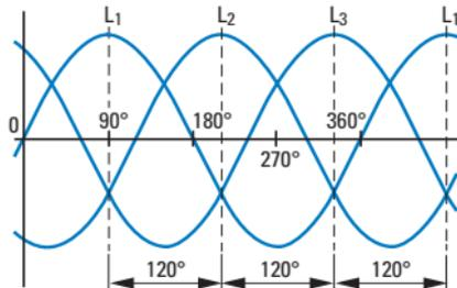
Beim Drehstrom-Asynchronmotor sind drei Wicklungsstränge um jeweils  $120^\circ/p$  ( $p$  = Polpaarzahl) gegeneinander versetzt angeordnet. Beim Aufschalten einer dreiphasigen, um jeweils  $120^\circ$  zeitlich verschobenen Wechselspannung wird im Motor ein Drehfeld erzeugt.
