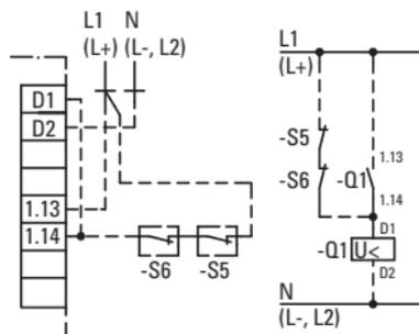
Leistungsschalter mit Unterspannungsauslöser bewirken Nullstellungszwang in Verbindung mit einem Verriegelungshilfsschalter am Anlasser (S5), Zusatzeinrichtungen am Motor (z. B. Bürstenabhebevorrichtung, S6) oder an allen Schaltern bei Mehrmotorenantrieben.
