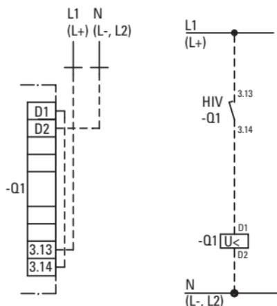
Der voreilende Hilfsschalter HIV (Q1) kann – wie oben gezeigt – den Unterspannungsauslöser in der AUS-Stellung des Leistungsschalters von der Steuerspannung abschalten. Soll der Unterspannungsauslöser 2-polig abgeschaltet werden, muss zwischen Klemme D2-N noch ein Schließer von Q1 geschaltet werden. Der voreilende Hilfsschalter HIV (Q1) legt den Unterspannungsauslöser stets so früh an Spannung, dass ein Einschalten möglich ist.
