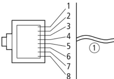
① Leitungseinführungsseite 8-poliger RJ45, EASY-NT-RJ45
