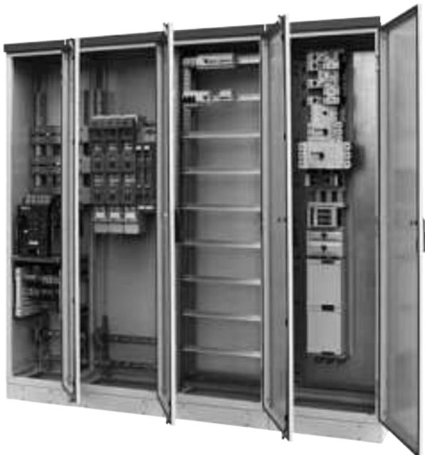
Der xVtl ist ein stabiler, anreihbarer Verteiler aus Stahlblech, der sich auch für die Einzelaufstellung bestens eignet. Er schützt den Menschen vor dem direkten Berühren aktiver Teile und somit vor einem möglichen elektrischen Schlag und wehrt schädigende Einflüsse von außen zuverlässig ab. Das erledigt er je nach Bedarf mit Schutzart IP40 oder IP55. Während sich erstere für diverse Einsätze in Zweckbauten wie Schulen oder Krankenhäusern anbietet, empfiehlt sich für rauere
