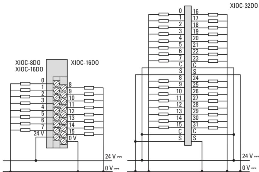
Schließen Sie bei induktiven Lasten eine Freilaufdiode parallel an.
