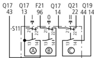
Der Motor läuft im Dreieck auf der niedrigen Drehzahl. Wird jetzt Taster II betätigt, wird die Spule von Q17 entregt, und über Q17/22-21 die Spule von Q21 erregt. Selbsthaltung über Q21/43-44: Über Schließer Q21/14-13 wird wieder die Spule von Sternschütz Q23 an Spannung gelegt. Der Motor läuft in hoher Drehzahl weiter.
