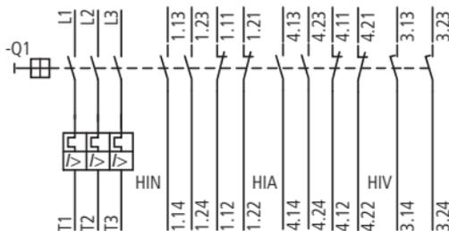
Für die Hilfsschalter werden die Kontaktelemente M22-K10 (K01, K20, K02, K11) aus dem RMQ-Titan-Programm von Eaton verwendet. Zusätzlich stehen zwei voreilende Hilfsschalter (2 S) zur Verfügung.
