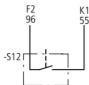
Ein neuer Anlauf ist nur möglich, wenn vorher Taster 0 betätigt wird, oder bei Überlast Öffner 95-96 am Motorschutzrelais F2 ausgeschaltet hat. Bei Dauerkontaktgeber muss das Motorschutzrelais F2 immer auf Wiedereinschaltsperr gestellt werden. Hat F2 den Motor ausgeschaltet, kann der Motor erst wieder anlaufen, wenn die Wiedereinschaltsperr gelöst wird.
