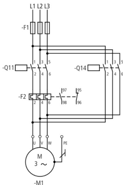
**Anschluss bei Motorschutzschalter
