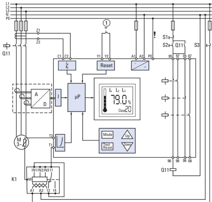
Kurzschlüsse im Thermistorkreis können bei Bedarf durch den zusätzlichen Einsatz eines Stromwächters K1 (z. B. Typ EIL 230 V AC der Fa. Crouzet) erfasst werden.
