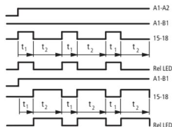
Nach Anlegen der Spannung  $U_s$  an A1 und A2 geht der Wechsler des Ausgangsrelais in die Stellung 15-18 (impulsbeginnend). Durch eine Brücke zwischen den Kontakten A1 und B1 kann das Relais auf pausenbeginnend umgeschaltet werden. Die Zeiten  $t_1$  und  $t_2$  können unterschiedlich eingestellt werden.
