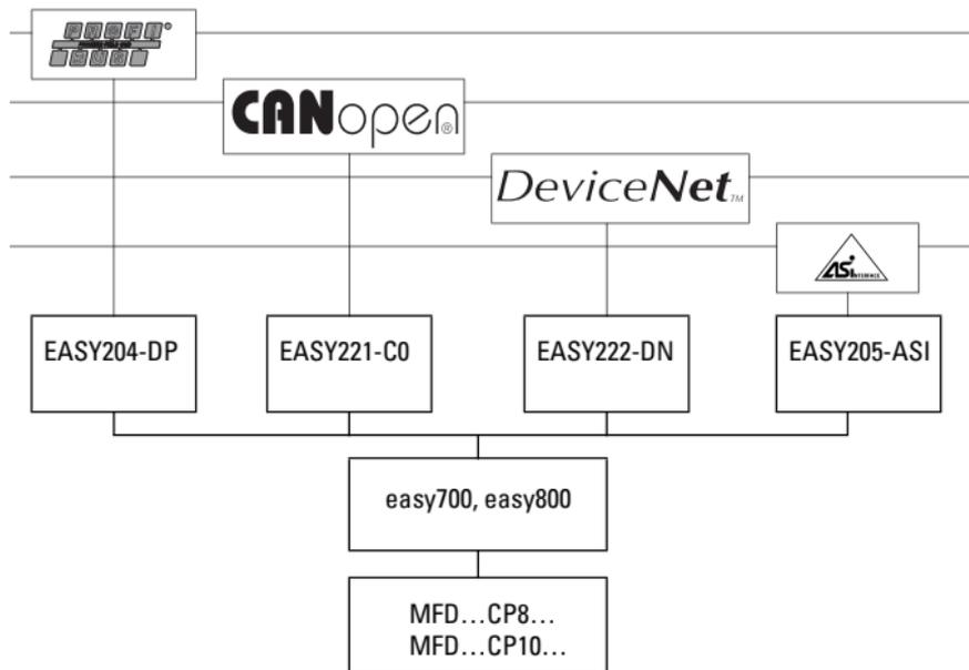
Ein Netzwerkmodul kann mit easy700, easy800 oder MFD(-AC)-CP8... verbunden werden. Das Netzwerkmodul ist als Slave in die Konfiguration einzubinden.
