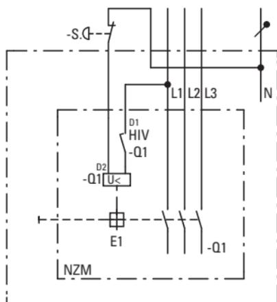
In der AUS-Stellung des Hauptschalters sind alle Steuerelemente und Steuerleitungen, die den Schaltschrank verlassen, spannungsfrei. Spannungsführend bleiben lediglich die Steuerspannungsabgriffe mit den Steuerleitungen zu den voreilenden Hilfsschaltern.
