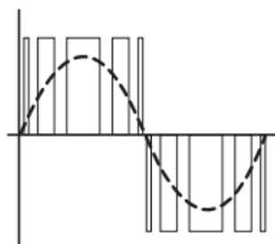
Ausgangsspannung = geschaltete Zwischenkreisspannung mit sinusbewerteter Puls-Weiten-Modulation (PWM)
