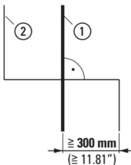
Die Motorleitung muss räumlich getrennt von den Steuer- und Signalleitungen (> 30 cm) und darf nicht parallel zu Netzleitungen verlegt werden.
