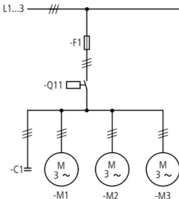
Einschwingvorgänge mit hohen Stromspitzen beanspruchen Schütze beim Einschalten von Kondensatoren stark. Beim Einschalten eines einzelnen Kondensators können Ströme bis zum 30-fachen des Bemessungsstroms auftreten, was allerdings für die Leistungsschütze DIL von Eaton kein Problem ist.
