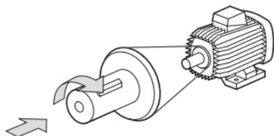
Unabhängig von der Schaltungsart und der Ausprägung des Drehstrom-Asynchronmotors sind die Anschlüsse so gekennzeichnet, dass in alphabetischer Reihenfolge (z. B. U1, V1, W1) bei Anschluss der Netzspannung in zeitlicher Phasenfolge (L1, L2, L3) der Rechtslauf bewirkt wird.
