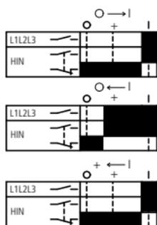
Hilfsschalter dienen zur Befehls- und Signalabgabe von Vorgängen, die von der Stellung der Schaltstücke bestimmt werden. Sie können für Verriegelungen mit anderen Schaltern und zur Fernmeldung des Schaltzustandes benutzt werden.
