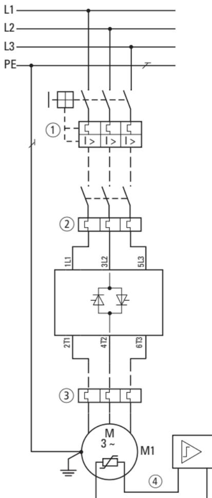
Der Motorschutz schützt den Drehstrom-Asynchronmotor vor thermischer Überlastung aufgrund mechanischer Überlastung oder beim Ausfall eines bzw. zweier Anschlussleiter.
