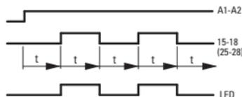
Nach Anlegen der Spannung  $U_s$  an A1 und A2 bleibt der Wechsler des Ausgangsrelais entsprechend der eingestellten Blinkzeit in der Stellung 15-16 und geht nach Ablauf dieser Zeit in die Stellung 15-18 (Der Zyklus beginnt mit einer Pausen-Phase).
