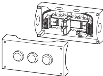
Die Schaltstellungsanzeigen der Bedienelemente sowie das Ansteuern der Leuchtmelder erfolgt über das SmartWire-DT Kommunikationssystem. Zur Verfügung stehen die in der Tabelle genannten Funktionselemente.
