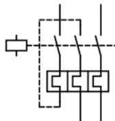
Ein wichtiges kennzeichnendes Merkmal von Überlastrelais sind nach IEC/EN 60947-4-1 die Auslöseklassen (CLASS 10 A, 10, 20, 30). Sie legen für die verschiedenen Anlaufbedingungen von Motoren (Normalanlauf bis Schweranlauf) unterschiedliche Auslösekennlinien fest.
