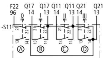
Die Reihenfolge der Drehzahl von niedriger auf hohe Drehzahl ist beliebig. Stufenweise Rückschaltung von hoher auf mittlere oder niedrige Drehzahl ist nicht möglich. Ausschalten jeweils mit Taster 0. Bei Überlast kann außerdem der Öffner 95-96 der Motorschutzrelais F2, F21 und F22 ausschalten.
