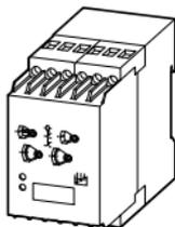
Die Niveaurelais EMR...-N kommen im Wesentlichen zum Trockenlaufschutz von Pumpen oder als Niveauregulierung von Flüssigkeiten zum Einsatz. Sie arbeiten mit Hilfe von Sensoren, die die Leitfähigkeit messen. Hierzu werden jeweils ein Sensor für die maximale und ein Sensor für die minimale Füllhöhe benötigt. Ein dritter Sensor dient als Massepotential.
