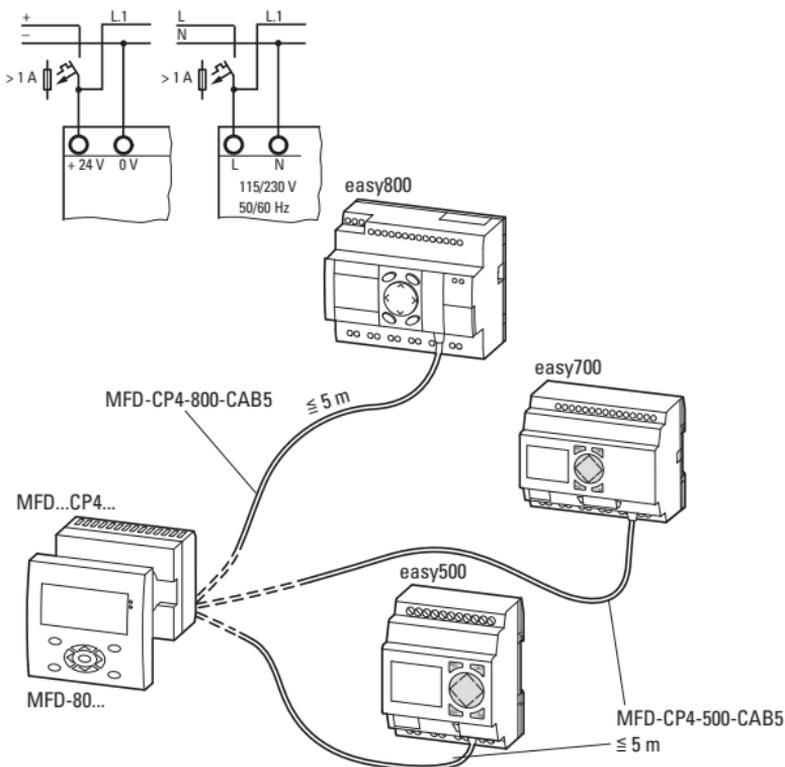
Auf dem „abgesetzten Display“ MFD-80... wird die Display-Anzeige des easyRelay abgebildet.
