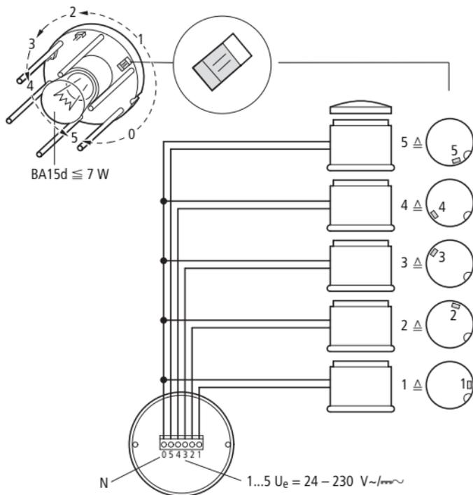
Von einer Klemmleiste im Basismodul werden fünf Signalleitungen durch jedes Modul geführt. Mit Hilfe einer Drahtbrücke (Jumper) auf jeder Leiterplatte wird das Modul adressiert. Fünf verschiedene Adressen können auch mehrfach vergeben werden.
