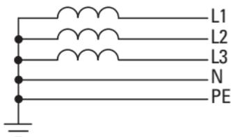
Anschluss und Betrieb an asymmetrisch geerdeten Netzen wie beispielsweise phasengeerdeten Dreiecknetzen (Grounded Delta, USA) oder nicht bzw. hochohmig geerdeten ( $> 30 \Omega$ ) IT-Netzen sind nur bedingt zulässig und erfordern zusätzliche Projektierungsmaßnahmen.
