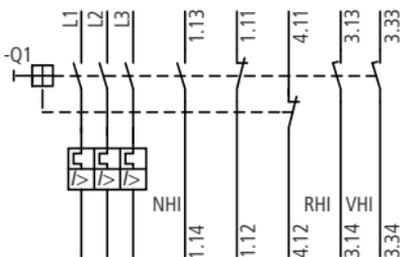
In den Leistungsschalter NZM7 können zwei Hilfsschalter-Bausteine als NHI (Ö oder S) sowie ein Ausgelöstmelder als RHI (Ö oder S) eingebaut werden. Es werden Kontaktelemente EK01/EK10 aus dem Programm der Befehls- und Meldegeräte RMQ von Eaton verwendet. Zusätzlich stehen voreilende Hilfsschalter (2 S) zur Verfügung.
