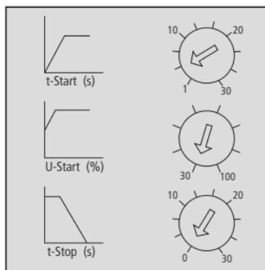
t-Start = Rampenzeit (1 - 30 s) für die Spannungserhöhung von dem Wert U-Start bis zur Netzspannung ( $U_{LN}$ )
