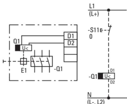
Ein abfallverzögerter Unterspannungsauslöser (Q1) ist eine Kombination aus separater Verzögerungseinheit (UVU) und zugehörigem Auslöser. Er verhindert, dass kurzzeitige Spannungsunterbrechungen zu einer Abschaltung des Leistungsschalters führen. Die Verzögerungszeit kann zwischen 0,06 und 16 s eingestellt werden.
