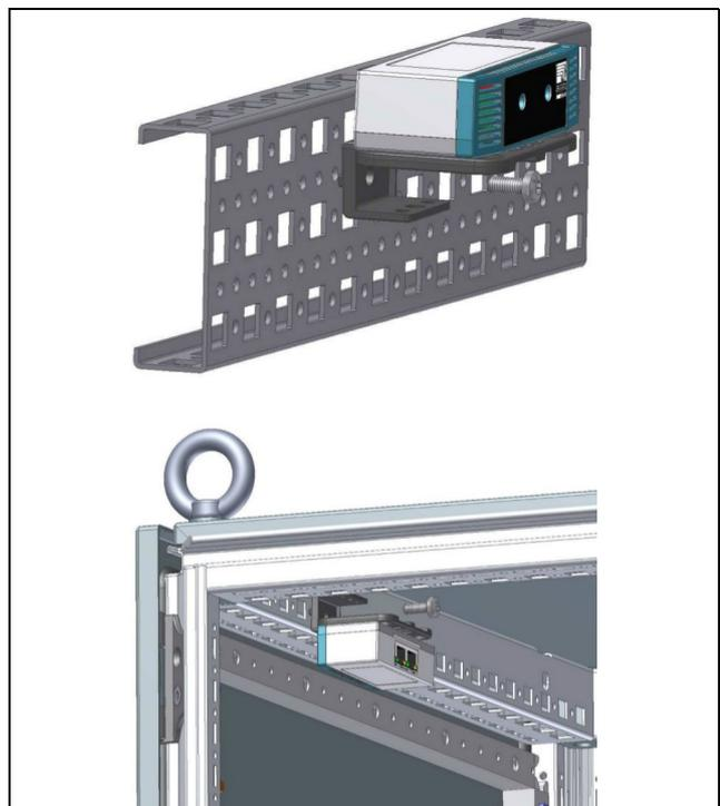
Abb. 4: Befestigen des Sensors im Schaltschrank bzw. IT-Schrank
