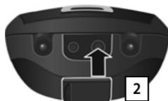
Wenn Sie **kein** Headset anschließen, setzen Sie die mitgelieferte Gummiabldeckung ein **2**, um den Spritzwasserschutz zu gewährleisten.
