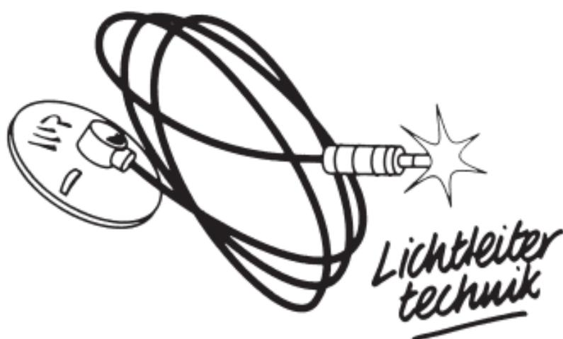
Ein Lichtleiter mißt sowohl die einfallenden Sonnenstrahlen als auch den Dämmerungszustand am Abend. Bei intensiver Sonneneinstrahlung senkt sich der Rollladen bis zum Sensor. Bei Dämmerungsfunktion wird der Befehl zum Senken bei Erreichen der Dämmerung gegeben. Die Werte für den gewünschten Sonnen- bzw. Dämmerungszustand können über Justierschrauben und mit Hilfe entsprechender Symbole am Gerät verändert werden.
