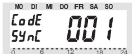
Es folgt das Synchronisieren des (ersten) Ventilantriebes („001“ im Display) auf den neuen Gerätecode.
