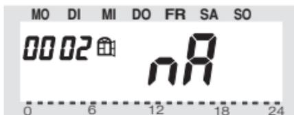
Durch Betätigen der „PROG“-Taste wird die Statusanzeige der Tür-Fenster-Kontakte beendet und der Regler kehrt in den normalen Betriebsmodus zurück.
