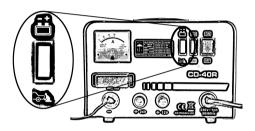
Erst dann, ganz zum Schluss, wird der Netzstecker des Ladegerätes in die 230V Netzsteckdose gesteckt und der Hauptnetzschalter des Gerätes auf **ON** gestellt. Das Gerät ist nun eingeschaltet und arbeitet
