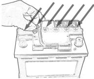
Jetzt den Säurestand in den Batteriezellen prüfen. Der Säurestand sollte bei entladener Batterie immer noch ca. 0,5 - 1 cm oberhalb der Bleiplatten in den Batteriezellen liegen. Ist dies nicht der Fall, muss destilliertes Wasser nachgefüllt werden. Es darf auf keinen Fall Leitungswasser benutzt werden. Bei zunehmendem Ladezustand steigt der Pegel der Säure. Damit die Batterie nicht überläuft, darf die Säure zu Beginn des Ladevorgangs nicht bis zur Maximalmarkierung aufgefüllt werden.
