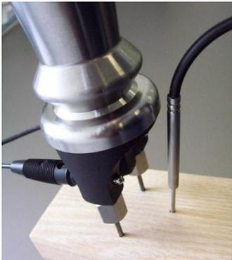
**Hohlhammerlektrode GHE91 mit Temperaturfühler GTF38**
