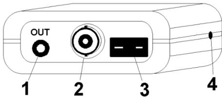
1. **Geräteausgang:** Betrieb als Schnittstelle: Anschluss für galv. getrennten Schnittstellenadapter (Zubehör: GRS 3100, USB3100)
