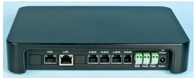
Etlliche Buchsen findet man an der Rückseite (von links nach rechts): CAN-Bus, LAN-Netzwerk, X-Bus, R-Bus (Rückmeldung), LocoNet, B-Bus (Booster), Sniffer-Bus (Auslesen der Daten von Fremdgeräten), Programmiergleis, Hauptgleis und Netzteil
