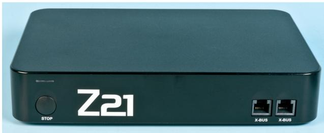
Die Z21 ist eine echte „Blackbox“, einziges Bedienelement an der Front ist die Stopp-Taste. Außerdem gibt es hier zwei Anschlüsse für den X-Bus, an den z.B. die verschiedenen Roco-Lokmäuse passen, die als Fahrregler zum Einsatz kommen können
