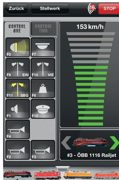
Das Fahrpult am iPhone - rechts der Geschwindigkeitsbalken, darunter Lokfoto und Richtungspfeile, links die Symbole der Sonderfunktionen, darunter die Lokliste
