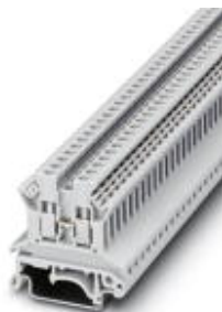
Durchgangsklemme, Anschlussart: Schraubanschluss, Querschnitt: 0,2 mm 2 - 4 mm 2 , AWG: 24 - 14, Breite: 5,2 mm, Farbe: weiß, Montageart: NS 35/7,5, NS 35/15
