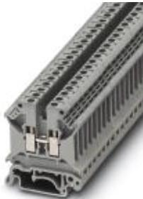
Durchgangsklemme, Anschlussart: Schraubanschluss, Polzahl: 1, Querschnitt: 0,2 mm<sup>2</sup> - 6 mm<sup>2</sup>, AWG: 24 - 10, Breite: 6,2 mm, Farbe: grau, Montageart: NS 32, NS 35/7,5, NS 35/15
