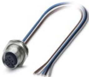
Sensor-/Aktor-Einbaubuchse, 5-polig, M12-SPEEDCON, A-kodiert, Hinterwand-/Schraubmontage mit M16 Gewinde, mit 0,5 m TPE-Litze, 5 x 0,34 mm 2
