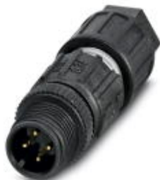
Sensor-/Aktor-Steckverbinder, 4-polig, Stecker gerade M12, A-kodiert, Schneidklemmanschluss, Rändelmaterial: Kunststoff, Kabelaußendurchmesser 3,5 mm ... 6 mm
