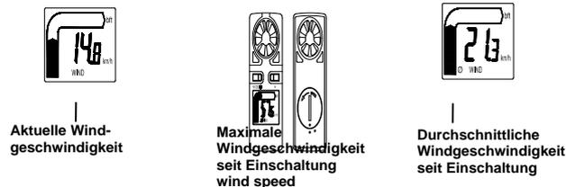
Zur Umschaltung zwischen den Anzeigen von aktueller Windgeschwindigkeit, maximaler und durchschnittlicher Windgeschwindigkeit ist einfach die **"+"-Taste** zu drücken.
