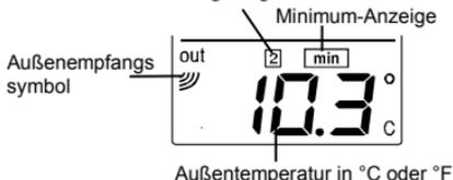
Die vierte Sektion des LCD-Bildschirms zeigt die Außentemperatur und ein Empfangssignal. Wenn mehr als ein Außensender eingesetzt ist, wird auch eine
