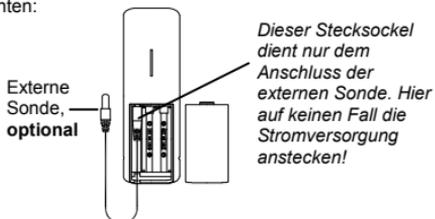
1. Ziehen Sie den Batteriefachdeckel zum Abnehmen nach unten.
