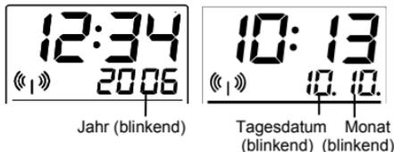
Die Kalendervoreinstellung der Temperaturstation ist der 1.1. des Jahres 2006. Wird das funkgesteuerte DCF-Zeitsignal empfangen, wird damit automatisch auch das Kalenderdatum auf den neuesten Stand gebracht. Ist kein DCF-77-Signalempfang möglich, so kann das Datum auf folgende Weise auch manuell eingestellt werden:
