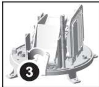
3. Entfernen Sie das Klebeband.
