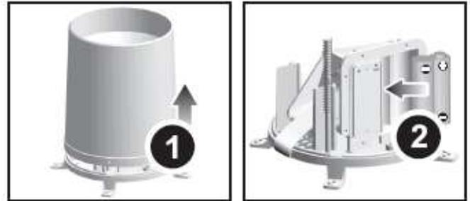
1. Entfernen Sie die Schrauben und ziehen Sie die Abdeckung nach oben hin ab.
