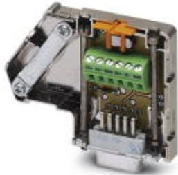
D-SUB Stecker, 9-polige Buchse, zwei Kabelzuführungen unter 35° auf eine Klemmreihe, Bussystem: CAN, CANopen®, SafetyBus-P bis 1 MBit/s, Abschlusswiderstand über Schiebeschalter zuschaltbar, Pinbelegung: 2,3,7; Schraubanschlussklemmen
