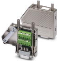
D-SUB-Stecker, 9-polig, Stift, zwei Kabelzuführungen unter 35°, Universaltyp für alle Systeme, Pinbelegung: 1, 2, 3, 4, 5, 6, 7, 8, 9 auf je eine Schraubanschlussklemme
