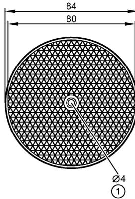
1: Ø Schraubenkopf bis 7,5 mm
