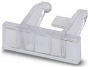
Klemmenleistenmarker, zur Leistenkennzeichnung, aufrastbar auf Endhalter E/UK oder CLIPFIX 35, Schriftfeldgröße: 25 x 6 mm
