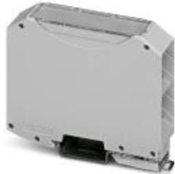
Elektronikgehäuse, bestehend aus: Gehäuseschalen links und rechts, Blende, Klarsichtdeckel, Metallfußriegel und Feder, Gehäuse geschlossen, 16-polig (4 x 4 Pole), Bauform: superflach, Breite: 22,5 mm, Farbe: lichtgrau
