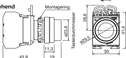
Alle Abmessungen in mm
