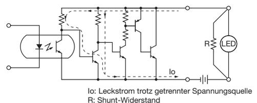
Schalten Sie den Shunt-Widerstand R parallel zur LED.
