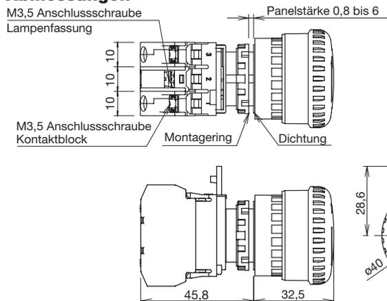
Hinweis: Der Taster wird beim Betätigen verriegelt und entweder durch Drehen oder Ziehen wieder entriegelt.
