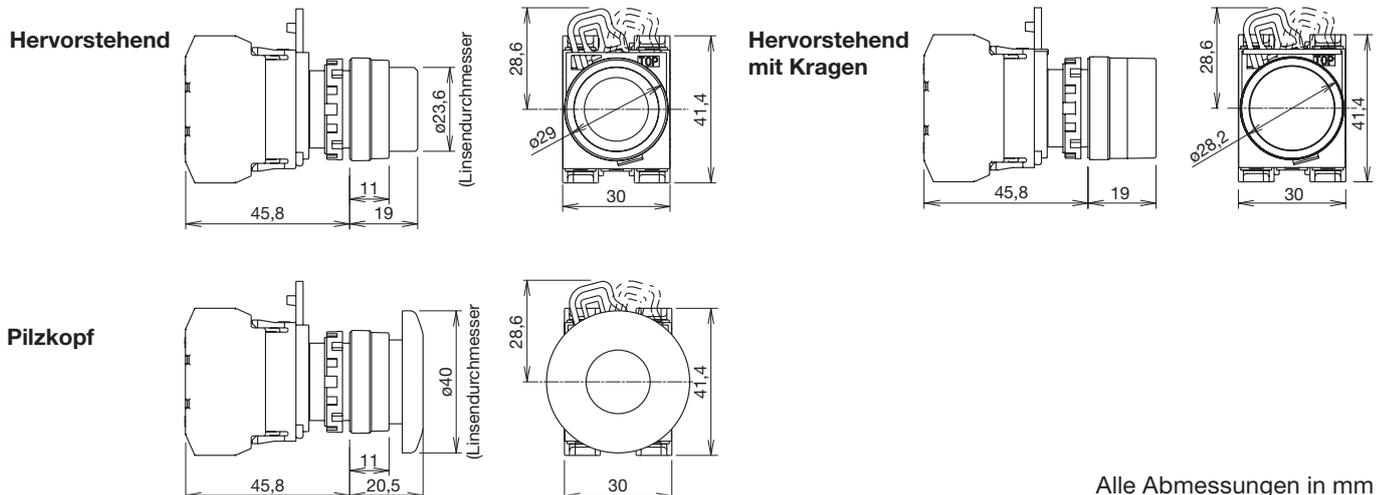
Alle Abmessungen in mm
