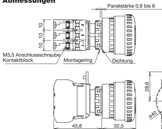
Hinweis: Der Taster wird beim Betätigen verriegelt und entweder durch Drehen oder Ziehen wieder entriegelt.
