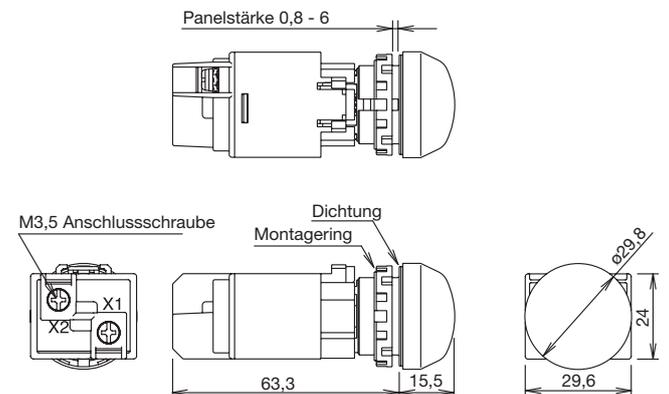
Alle Abmessungen in mm
