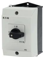
**EIN-AUS-Schalter, T0, 20 A, Aufbau, 2 Baueinheit(en), 3-polig, mit schwarzem Knebel und Frontschild**
