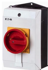
Hauptschalter, T0, 20 A, Aufbau, 2 Baueinheit(en), 3-polig, NOT-AUS-Funktion, mit rotem Drehgriff und gelbem Sperrkranz, abschließbar in 0-Stellung
