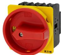
Hauptschalter, P3, 100 A, Einbau, 3-polig, NOT-AUS-Funktion, mit rotem Drehgriff und gelbem Sperrkranz, abschließbar in 0-Stellung
