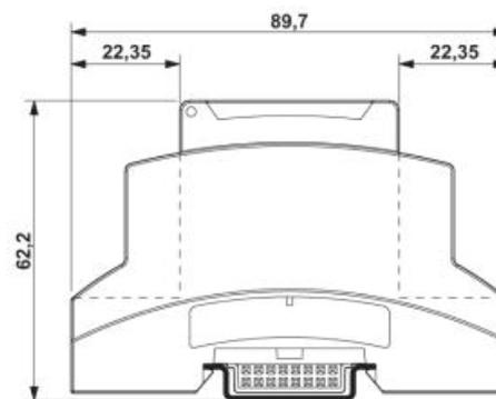
Maßzeichnung zeigt den Artikel mit Gehäuseoberteil (Klemmeneinbautiefe 22,35 mm) und Gehäusedeckel
