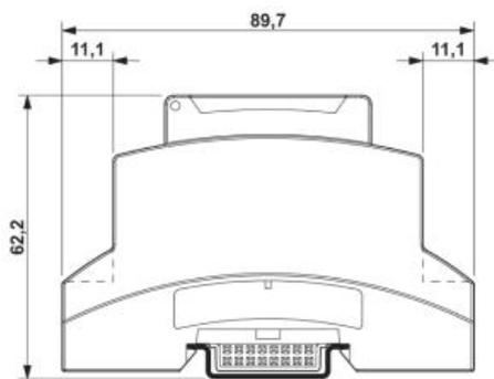
Maßzeichnung zeigt den Artikel mit Gehäuseoberteil (Klemmeneinbautiefe 11,1 mm) und Gehäusedeckel
