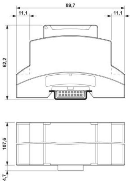
Maßzeichnung zeigt den Artikel mit Gehäuseoberenteil (Klemmeneinbautiefe 11,1 mm) und Gehäusedeckel
