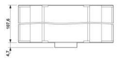
Maßzeichnung zeigt den Artikel mit Gehäuseoberteill (Klemmeneinbautiefe 22,35 mm) und Gehäusedeckel
