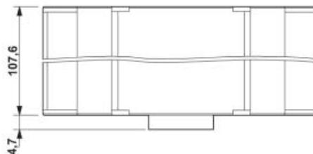
Maßzeichnung zeigt den Artikel mit Gehäuseoberteil (Klemmeneinbautiefe 22,35 mm) und Gehäusedeckel
