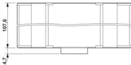
Maßzeichnung zeigt den Artikel mit Gehäuseoberteil (Klemmeneinbautiefe 11,1 mm) und Gehäusedeckel
