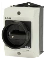
Hauptschalter, T0, 20 A, Aufbau, 2 Baueinheit(en), 3-polig, HALT-Funktion, mit schwarzem Drehgriff und Sperrkranz, abschließbar in 0-Stellung
