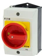
Hauptschalter, T0, 20 A, Aufbau, 1 Baueinheit(en), 2-polig, NOT-AUS-Funktion, mit rotem Drehgriff und gelbem Sperrkranz, abschließbar in 0-Stellung
