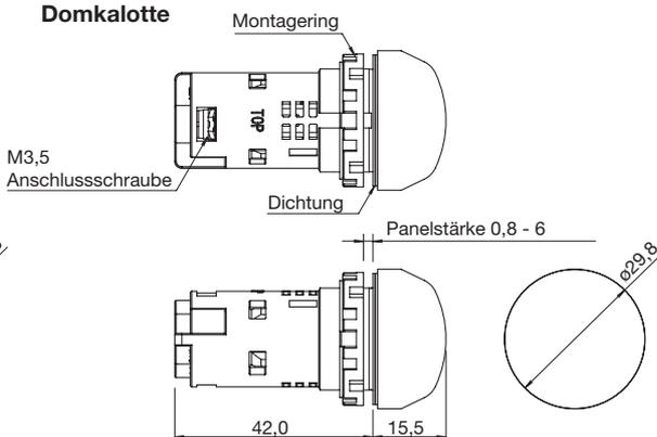
Alle Abmessungen in mm
