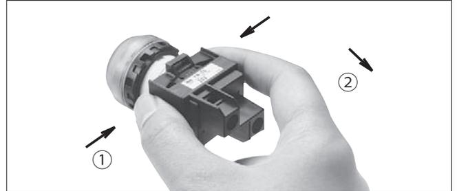
1. Um die Lampenfassung zu demontieren, drücken Sie die Laschen vorne von beiden Seiten ein (siehe Abbildung oben). Der Anschluss kann, wie der Transformator, auch mit einem flachen Schraubendreher entfernt werden. (Siehe links unten). Der Betätiger kann nun gelöst werden.
