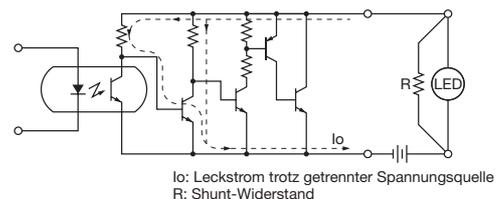
Schalten Sie den Shunt-Widerstand R parallel zur LED.
