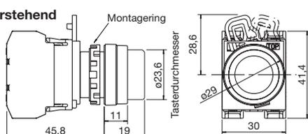
Alle Abmessungen in mm
