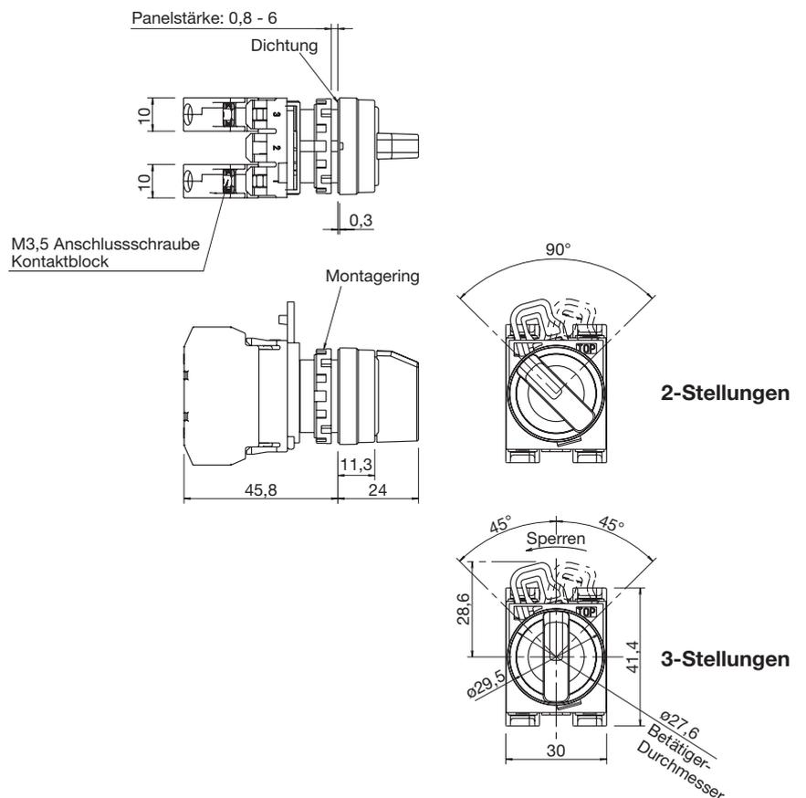
Alle Abmessungen in mm
