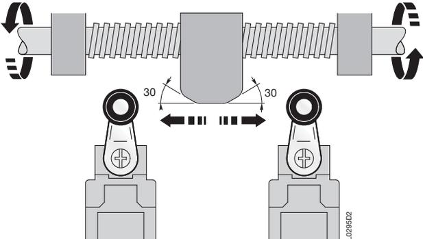
Für vergleichsweise langsame Bewegungen des Schaltauslöser sollte ein Positionsschalter mit Sprungkontaktblock bevorzugt werden.
