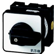
EIN-AUS-Schalter, 3-polig + 1 Schließer, 20 A, 90 °, Einbau
