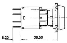
Die RAFIX®-Schaltelemente haben Flachsteckanschlüsse 2,8 x 0,8 mm, die einzeln durch Löten oder Stecken oder aber auch mit einem Gruppenanschlußstecker verdrahtet werden können.
