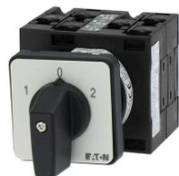
Wendeschalter, T3, 32 A, Einbau, 3 Baueinheit(en), Kontakte: 5, 60 °, rastend, mit 0-Stellung, 1-0-2, Abwicklungs Nr. 8401
