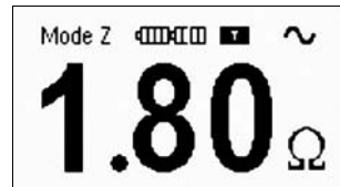
Bild 3.13 Beispiel Ergebnis der Impedanzmessung (Kurzdarstellung)
