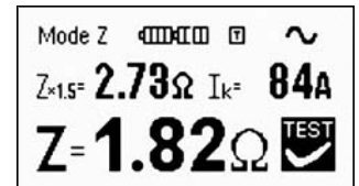
Bild 3.14 Beispiel Ergebnis der Impedanzmessung (detailliert)
