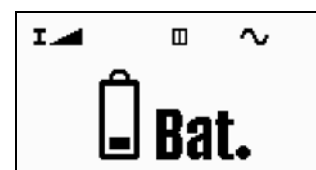
Bild 3.9 Zustand der Batterie nach Drücken von START
