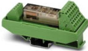
Universal-Sicherheitsrelais mit zwangsgeführten Kontakten, Federkraftanschluss, 4 Schließer, 2 Öffner, Breite: 40 mm
