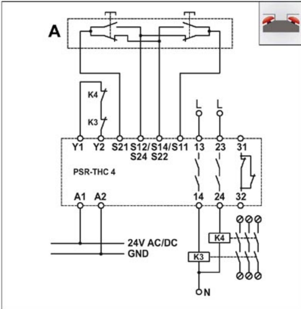
Überwachung von steuernden, trennenden Schutzeinrichtungen nach EN 1088 mit Gleichheitsüberwachung < 0,5 s, geeignet bis Sicherheitskategorie 4.
