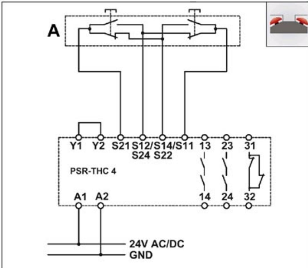
A = ZweihandbedienpultZweihand-Steuerungen mit Gleichheitsüberwachung < 0,5 s, entspricht EN 574 Typ III C, geeignet bis Sicherheitskategorie 4.
