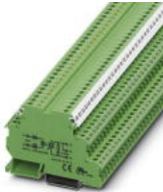
Leistungs-Solid-State-Relaisklemme, Eingang: 5 V DC, Ausgang: 10-253 V AC/800 mA, Klemmenbreite 6,2 mm
