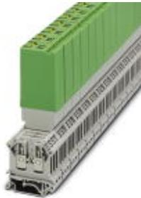
Relaisstecker für hohe Einschaltströme, Kontakte (AgCdO+voreilend W): mittlere bis große Leistungen, 1 Schließer, Eingangsspannung 24 V DC, max. Einschaltstrom 10 A
