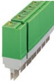
Relaisstecker, bestückt mit Kleinschaltrelais, Kontakte (AgNi): mittlere bis große Leistungen, 2 Wechsler, Eingangsspannung 120 V AC/DC, mit Leuchtanzeige, steckbar auf Grundklemmenblöcke
