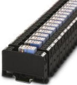
Relais-Modul für hohe Einschaltströme, mit fest eingelötetem Relais, Kontakte (AgCdO + voreilend W): mittlere bis große Leistungen, 1 Schließer, Eingangsspannung 24 V DC, max. Einschaltstrom 80 A
