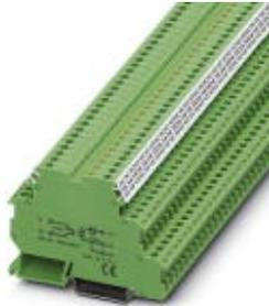
Leistungs-Solid-State-Relaisklemme für Aktor, Eingang: 24 V DC, Ausgang: 3-30 V DC/3 A, Klemmenbreite 6,2 mm
